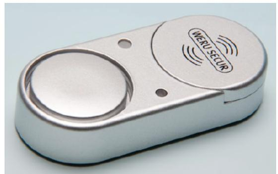
Der Glasbruchmelder kann nicht auf Sicherheitsgläser angebracht werden, da der Folienaufbau eine andere Glasbruchfrequenz bewirkt und somit die Funktionssicherheit nicht gegeben ist.
